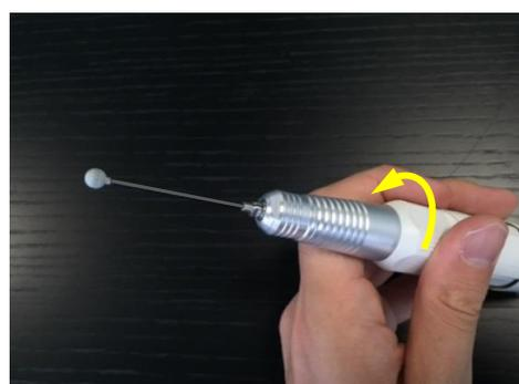
⑤ハンドピースのチャック開閉リングだけを、反時計回りにカチッと音が鳴るまで回し、ツールを固定します。
