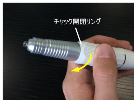
②ハンドピースのチャック開閉リングだけを、時計回りにカチッと音が鳴るまで回してください。
